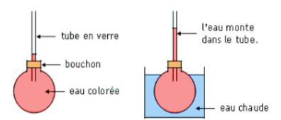
Une même quantité de liquide possède un volume plus grand si sa température est plus importante. On parle alors de dilatation thermique. Le coefficient de dilatation thermique indique la proportion en volume gagné pour chaque degré Celsius supplémentaire acquis par le liquide.
