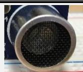
Un dispositif ultrasonore présente en façade une grille à travers laquelle les ultrasons sont émis ou captés par le dispositif.
