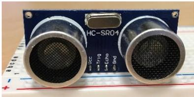
Vu de face, le dispositif ultrasonore présente un émetteur et un récepteur à ultrasons.
