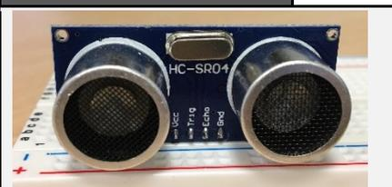
Vu de face, le dispositif ultrasonore présente un émetteur et un récepteur à ultrasons.
